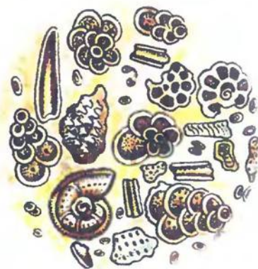
Рис. 25. Мел под микроскопом (увеличено в 150 раз)
